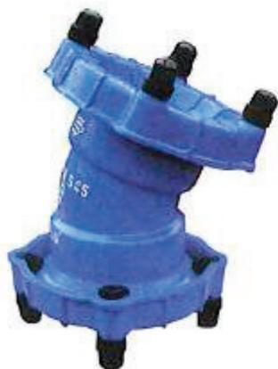
Na junta mecânica a estanqueidade é assegurada pela compressão axial de um anel de junta em elastómero por meio de uma contra-flange e de parafusos.
